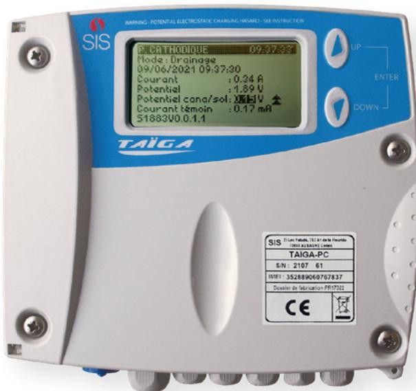
*TAIGA PC est la solution de télésurveillance de la protection cathodique qui répond à vos besoins.*
